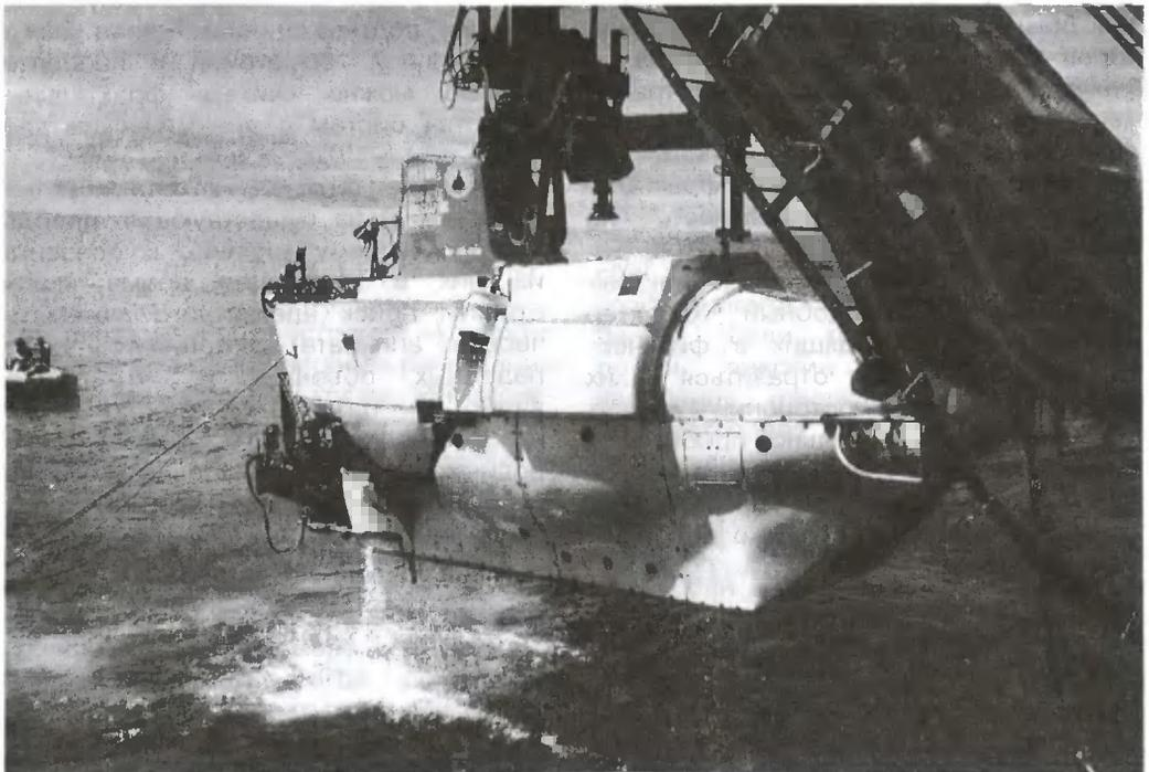
строй в 1964 г. и совершившего уже более 3300 спусков. В 1996 г., пока менялся корабль-носитель, подводники из Океанографического института в Вудс Холе полностью перебрали «Алвин», заменили некоторые из узлов гидравлической и электрической проводки, обновили обшивку и поменяли большой хвостовой пропеллер на группу маленьких движителей-трастеров. Титановую сферу аппарата во время ремонта не трогали, оставив максимальную рабочую глубину «Алвина» 4500 м.
